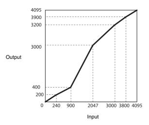
>LINEAR-INTERPOLATION 1 240 200 >LINEAR-INTERPOLATION 2 900 400 >LINEAR-INTERPOLATION 3 2047 3000 >LINEAR-INTERPOLATION 4 3000 3200 >LINEAR-INTERPOLATION 5 3800 3900 >LINEAR-INTERPOLATION-BUILD >LUT-FORMAT 3
